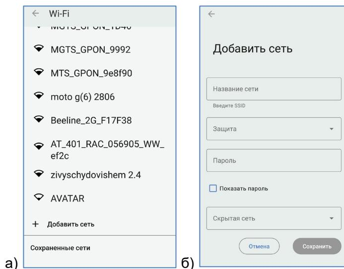
Рисунок 50 (а,б) А – расположение кнопки «+Добавить сеть». Б – экран функционала «Добавить сеть»
